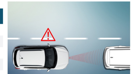
Alert o niebezpiecznej odległości od poprzedzającego pojazdu (SDW)
